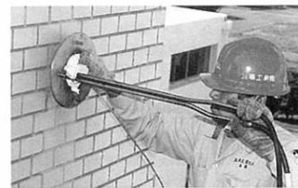
焼却炉排ガス測定
