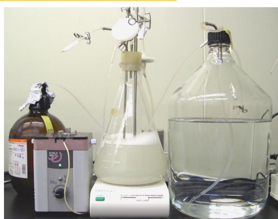
フェノールを唯一の炭素源とする培地で連続集積培養。フェノール資化性細菌のみが集積される。
